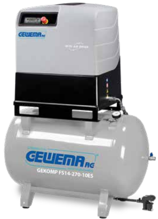
GEKOMP FS14-270-10ES inkl. 4x Schwingenelemente, Kondensatableiter und Doppelnippel
